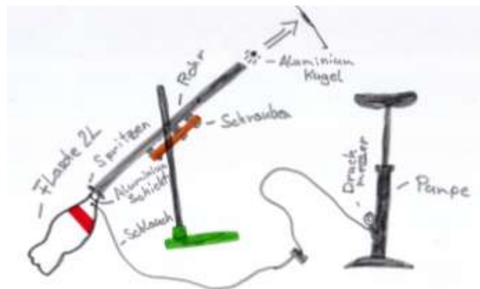
Abbildung 8 Geschwindigkeitsmessung und ein gezeichneter Versuchsaufbau
